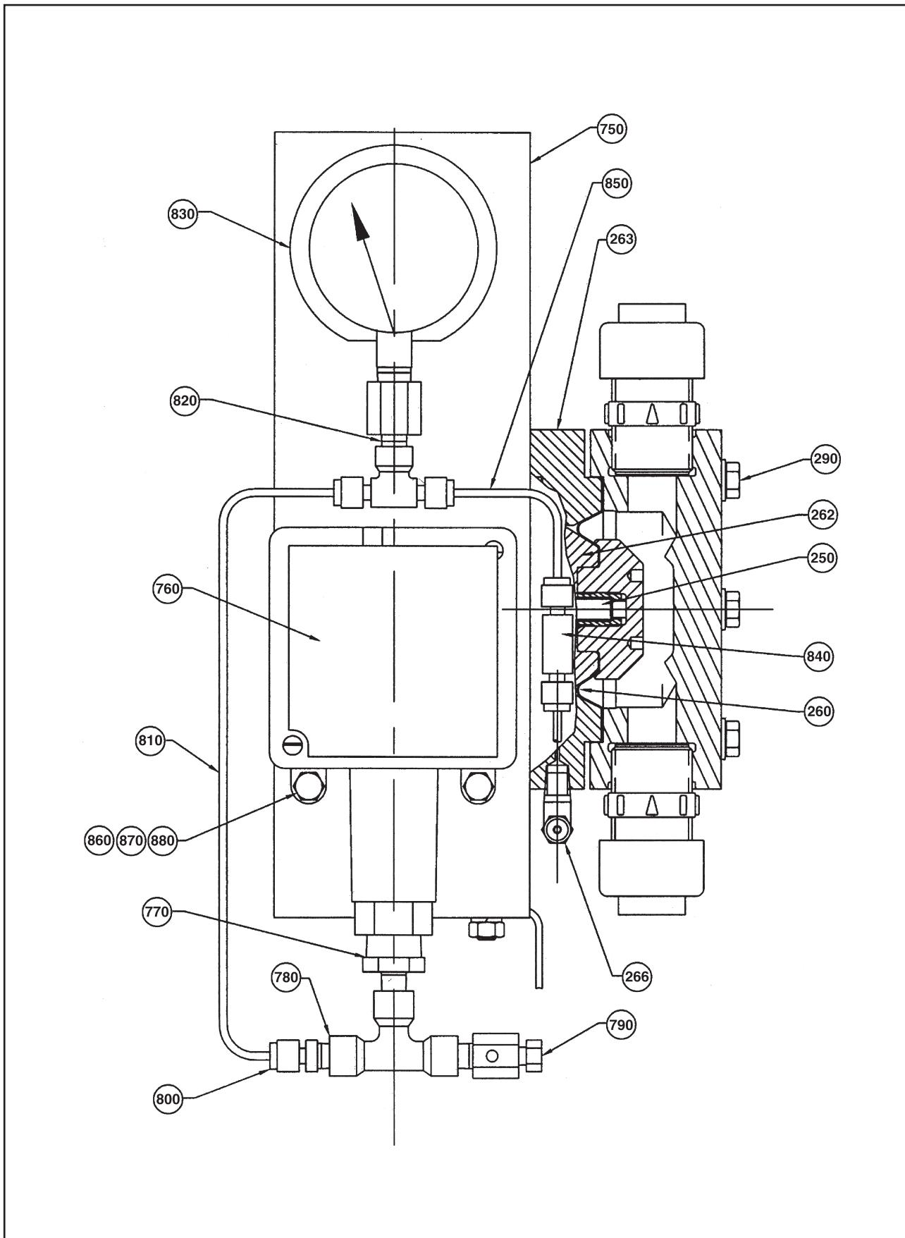
GB双隔膜液力端带压力表和压力开关零件清单 (参见图 6-2,6-17,6-18)
