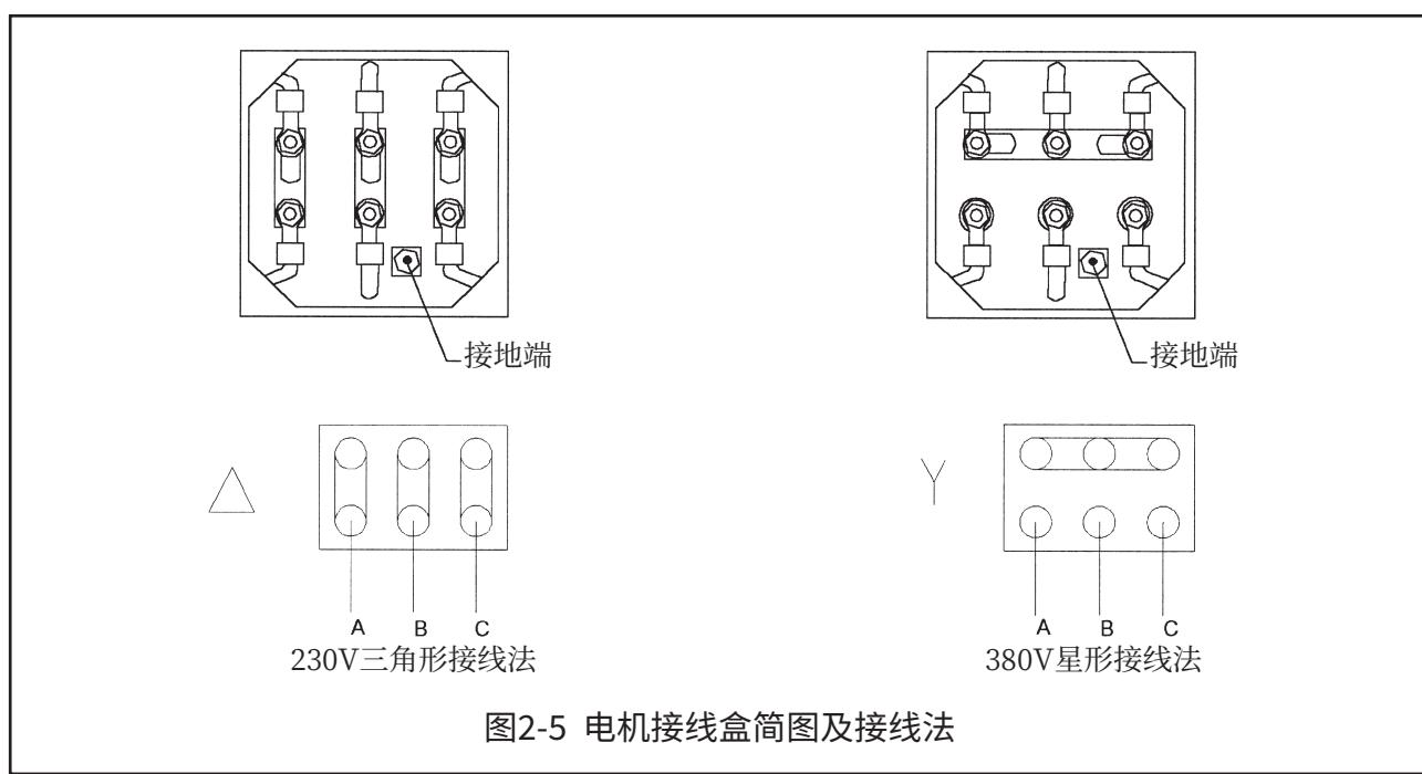
图2-5 电机接线盒简图及接线法
