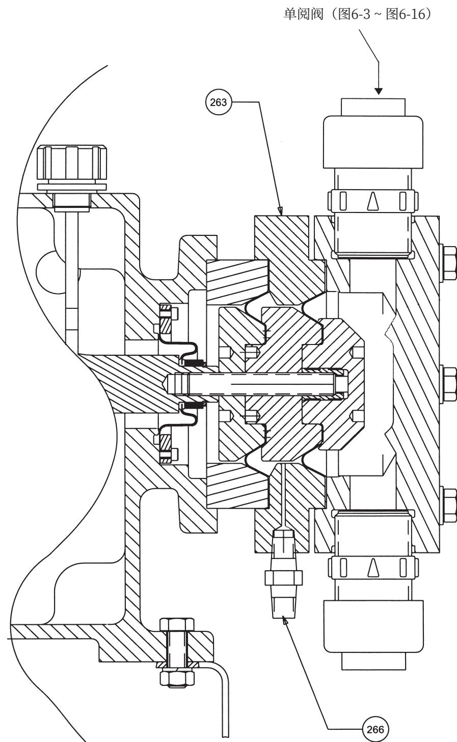
图6-18 泄漏检测，带压力表和压力开关（所有标准液力端）
